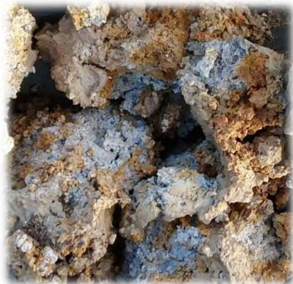
Exemple de traces d'oxydoréduction Source CERMECO
