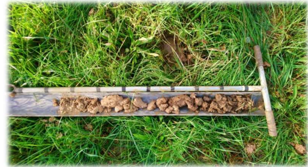
Profil de sol obtenu après sondage pédologique – Source CERMECO
